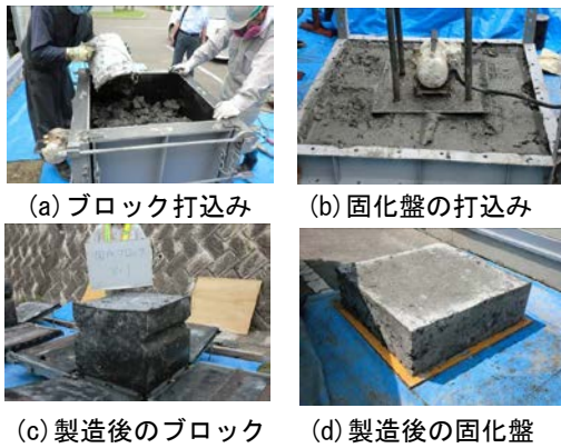
図7 焼却灰の超流体工法による固化実証試験 (RANDEC ニュース、Jul. 2013, No. 94, p12-14)
